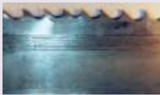
RAYURE PROFONDE SUR LES CÔTÉS DE LA LAME
