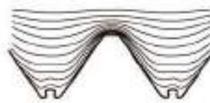
Filetage obtenu avec un taraud à refouler
